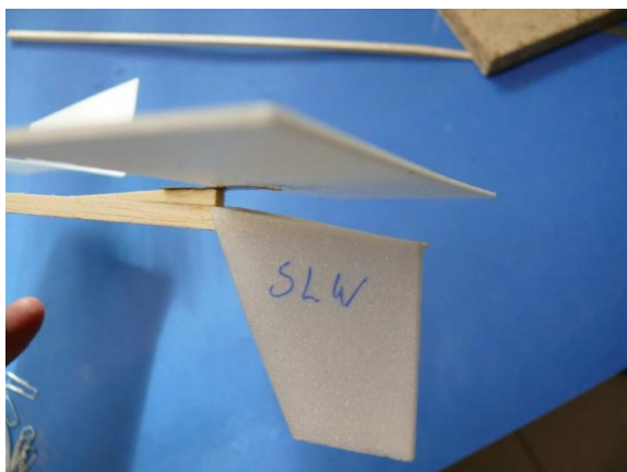
Abbildung 5 Das Höhenleitwerk ist zur Veränderung der EWD mit einem biegsamen Gelenk (Alu-Dosenblechstreifen) versehen
