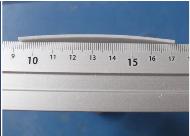
Abbildung 2 Das über einer Flasche gebogene Flügelprofil aus 1 mm Depron
