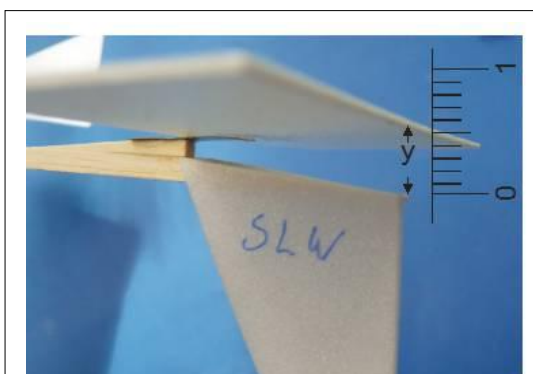
Abbildung 3 Der Abstand der HLW Hinterkante vom Rumpfhinterende in mm entspricht y
