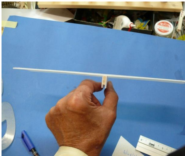
Abbildung 3 Prüfen auf Verzug: Flügel Vorder- und -Hinterkante müssen parallel sein!
